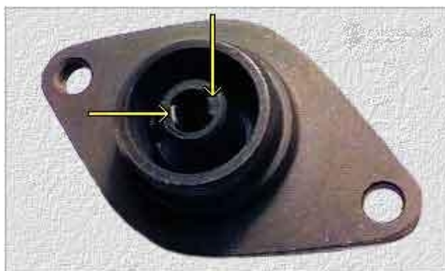
Рис.1.8. Направляющие втулки в передней опоре ротора
